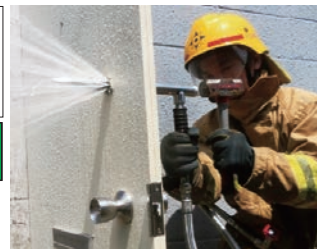
火源のあるドア内部を冷却し、火勢を抑制
